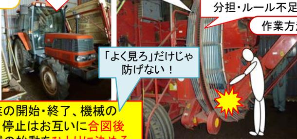
作業の開始・終了、機械の始動・停止はお互いに合図後 + 機械の始動をひとりに決める
